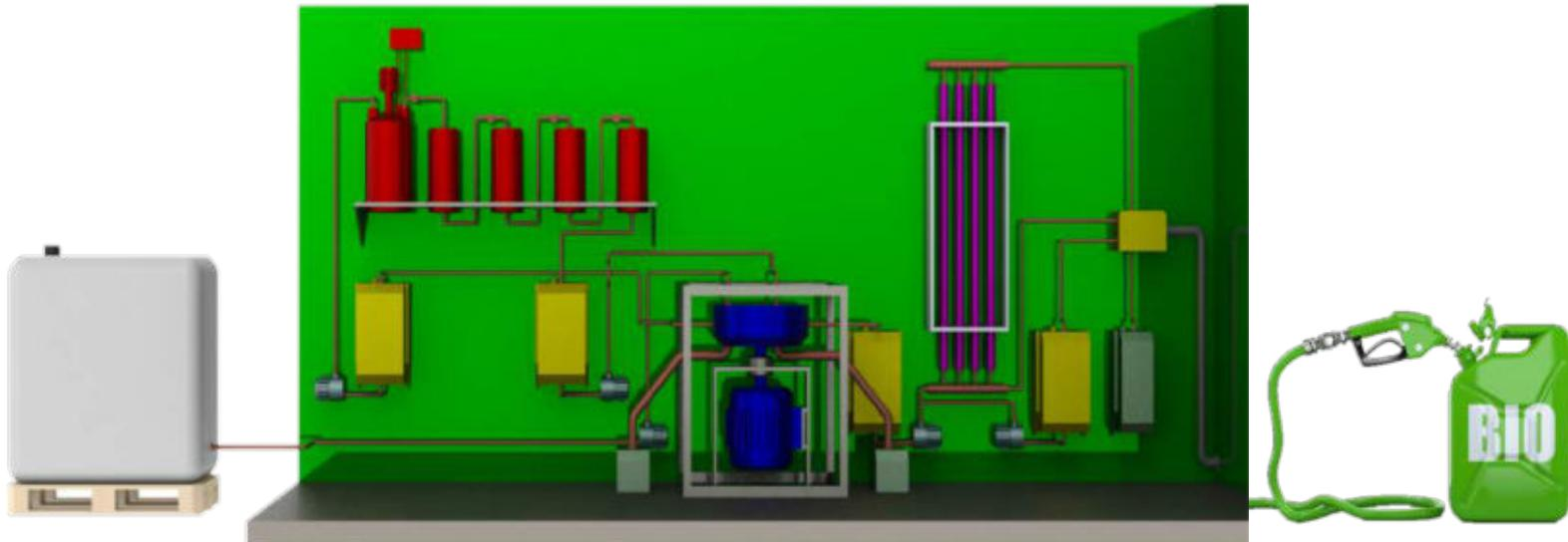
Containeranlage zur Butanolproduktion
